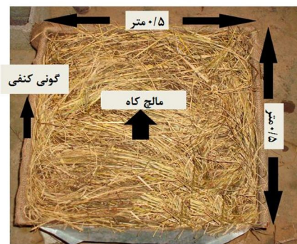
شکل ۲. نمایی از کورت فرسایشی پوشیده شده با کاه و کلش برنج مورد استفاده در پژوهش
