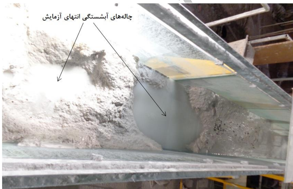
شکل ۴. چاله‌های آبشستگی ایجاد شده در انتهایی آزمایش
