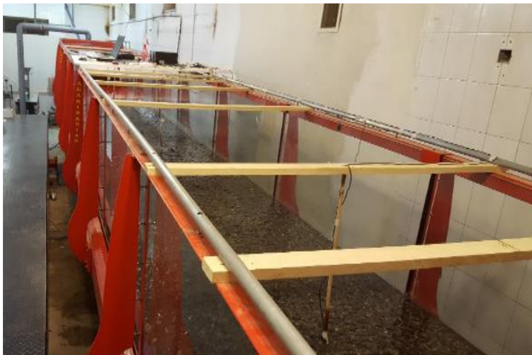
شکل ۲. کانال آزمایشگاهی با بستر سنگریزه‌ای و جانمایی سنسورهای اندازه‌گیری EC
