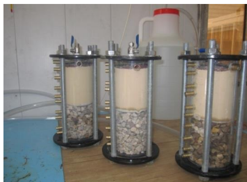
شکل ۲. اجزا دستگاه نفوذسنج همراه با سه نمونه پر شده یکسان برای شروع آزمایش
