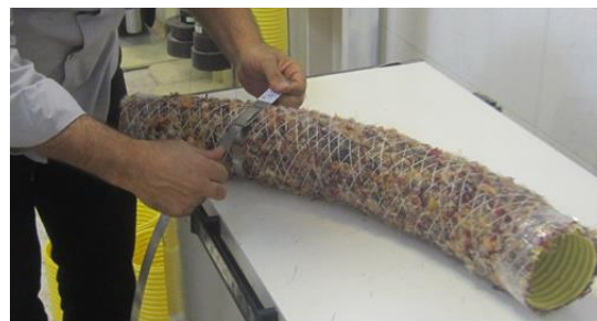
شکل ۳. اندازه‌گیری ضخامت پوشش‌های مصنوعی توسط سیرکومتر
