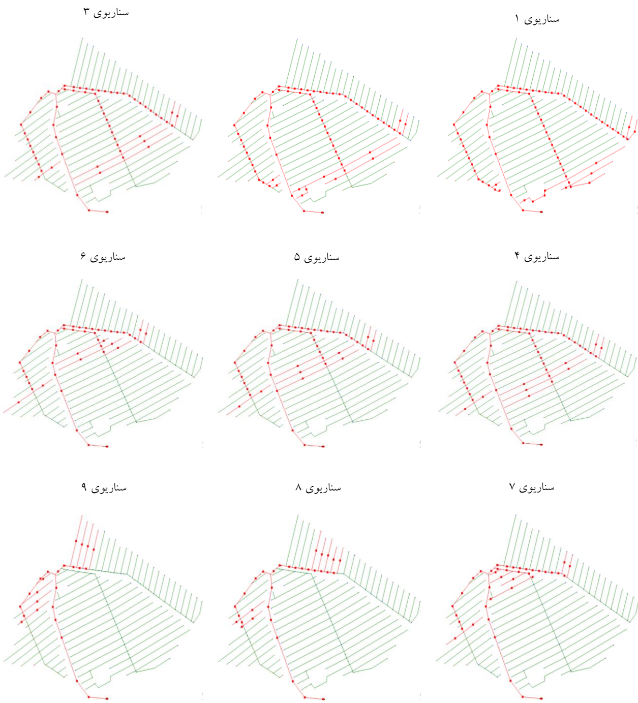
شکل ۲. موقعیت و لتراهای انتخابی شبکه جهت آبیاری همزمان در هر سناریو یا روز (خطوط قرمز لتراهای فعال و خطوط سبز لتراهای غیرفعال هستند)
