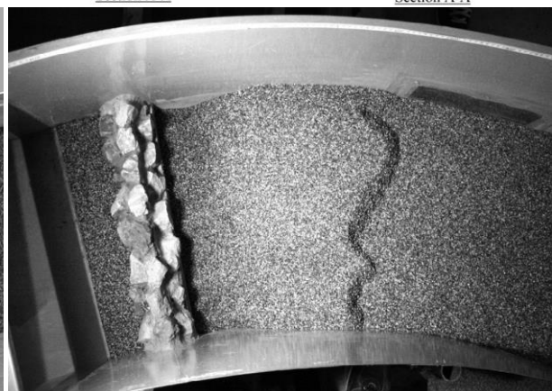
شکل ۲. طرح کلی مدل آزمایشگاهی سرریزهای سنگی درون کانال منحنی (a) شکل J (b) شکل U (c) شکل I
