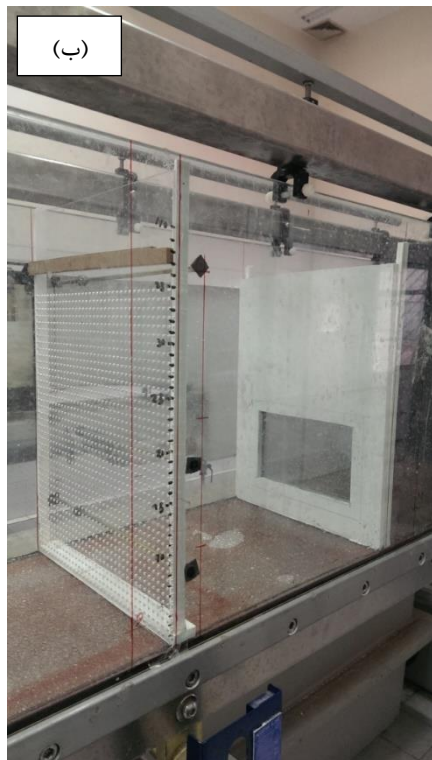
شکل ۵: الف) دریچه تنظیم جریان و تثبیت سطح آب، ب) دریچه کنترل و جداسازی مقطعی مواد جریان فلوم
