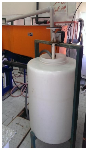
شکل ۷: مخزن تولید جریان غلیظ
