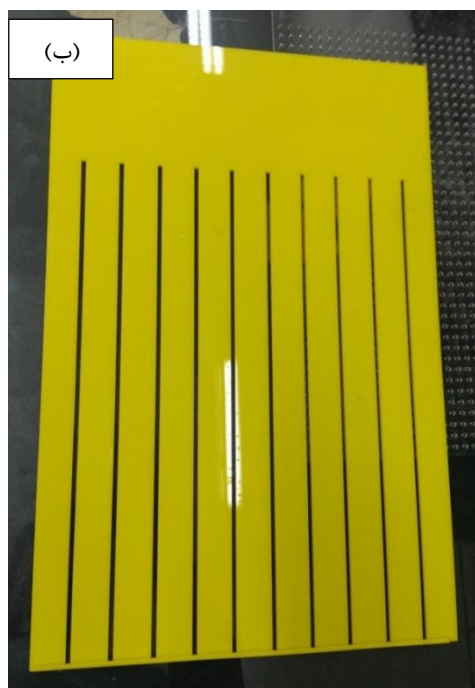
شکل ۳: الف) نمونه مانع حفره‌ای؛ ب) نمونه مانع شیاری
