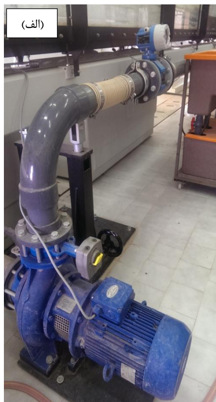
شکل ۴: الف) دبی سنج و تنظیم کننده جریان پایه، ب) دستگاه اینورتر تهیه هیدروگراف جریان غلیظ تزریقی
