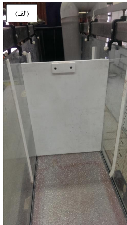
شکل ۵: الف) دریچه تنظیم جریان و تثبیت سطح آب، ب) دریچه کنترل و جداسازی مقطعی مواد جریان فلوم
