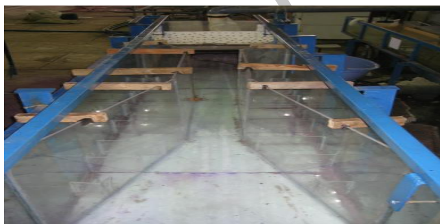
شکل ۲: نمایی از یک مقطع همگرای ایجاد شده در داخل فلوم
