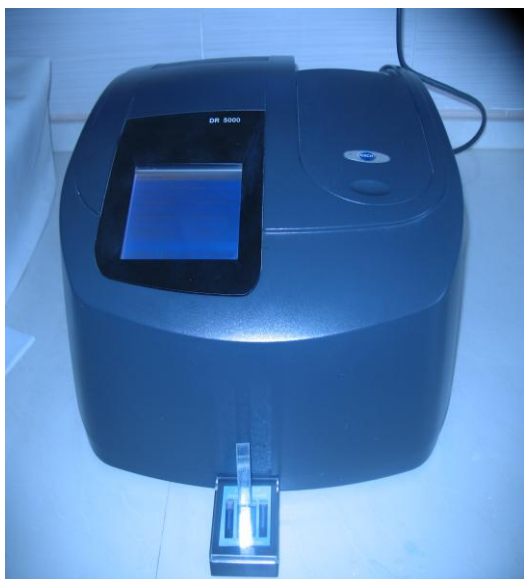
تصویر ۲. دستگاه اسپکتروفوتومتر HACH – DR – 5000
