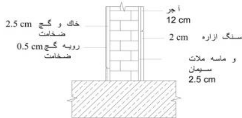
تصویر ۲- جزئیات اجرای دیوارهای مدرسه (http://www.liveroof.com/detail-drawings)
