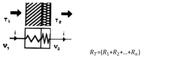
شکل (۲)- مقاومت حرارتی کل یک چدار چند لایه
