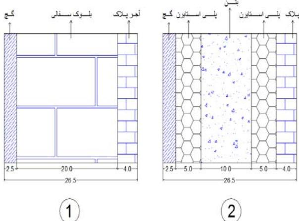
شکل (۳)- مقایسه میزان مقاومت حرارتی یک دیوار ساخته شده با تکنولوژی (ICFs) با یک دیوار سفالی معمول
