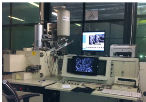
شکل ۳-۸: تهیه عکس میکروسکوپ الکترونی SEM
