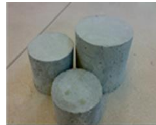
شکل ۲- نمونه‌های بدون هسته (الف: عکس بتن ساخته شده ب: مشخصات نمونه)
