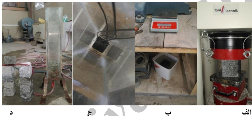
شکل ۴- الف) دستگاه ضریب آبگیری، ب) نمونه قرار داده شده در دستگاه، ج) ترازوی ارشمیدس و د) دستگاه تست مقاومت فشاری
