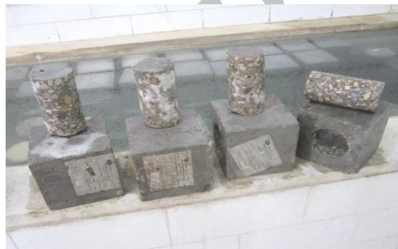
شکل ۹- مغزه‌گیری از نمونه‌های مکعبی
