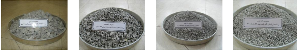
شکل شماره ۱- نمونه‌ای از دانه‌بندی سنگ دانه‌های بازیافتی مورد استفاده در بتن خود تراکم
