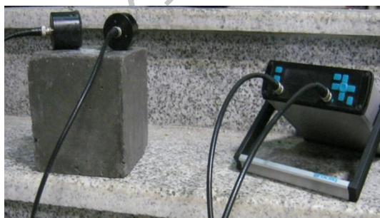
شکل شماره ۱۰- نمونه‌ای از انجام آزمایش فراصوتی
