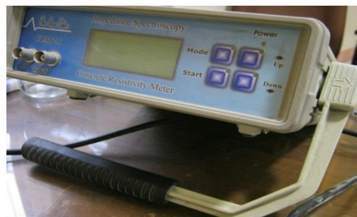
شکل شماره ۹- نمونه‌ای از انجام آزمایش مقاومت الکتریکی
