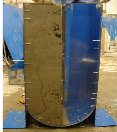
شکل شماره ۴- نمونه ای از نحوه انجام آزمایش یو
