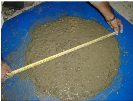
شکل شماره ۲- نمونه‌ای از نحوه انجام آزمایش جریان اسلامپ
