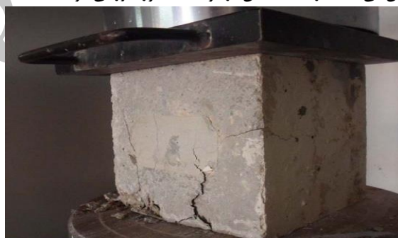
شکل شماره ۷- نمونه‌ای از انجام آزمایش مقاومت فشاری
