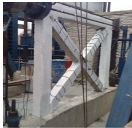
شکل ۱۳- ترک خوردگی در نمونه F2 حاصل از مطالعه آزمایشگاهی [۱۱]
