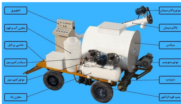
شکل ۴- مکانیزم دستگاه فوم بتن ساختمانی
