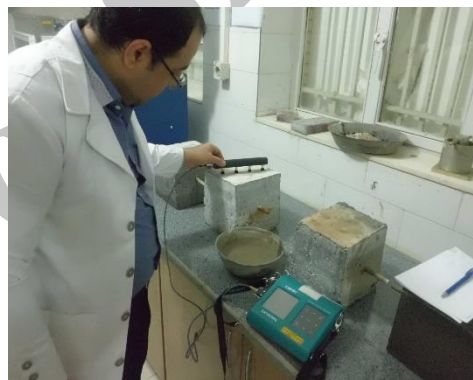
شکل ۳- انجام آزمایش اندازه گیری میزان مقاومت بتن در مقابل نفوذ یون کلر بوسیله دستگاه آلتراسونیک
