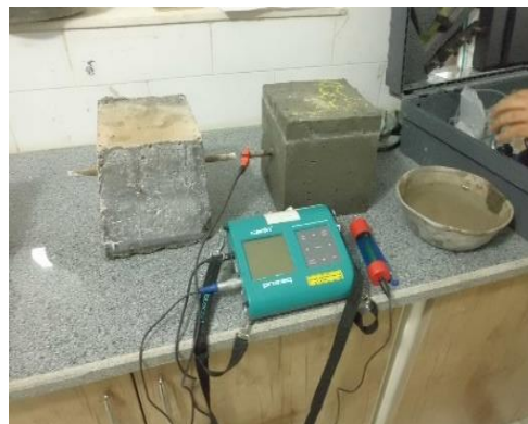
شکل ۲- آماده سازی دستگاه هالف سل جهت انجام تست خوردگی
