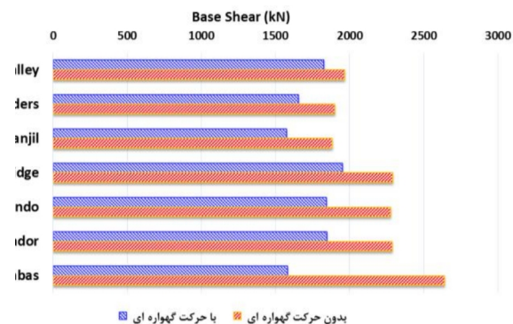
شکل ۱۱- مقایسه برش پایه سازه ۸ طبقه با رعایت بند آیین نامه، با و بدون در نظر گرفتن حرکت گهواره‌ای
