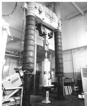
شکل ۱- آزمایش میراگر ویسکوز با بار ۲۰۰ تن در نیروی هوایی آمریکا (Douglas Taylor, et al)
