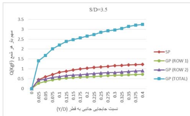
شکل ۸- پاسخ تغییر مکان-بار جانبی برای گروه شمع ۲*۲ در نسبت های فاصله به قطر متفاوت
