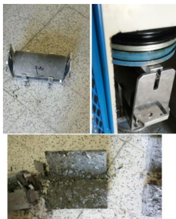
شکل ۴-۱۵ نحوه آماده‌سازی و آزمایش نمونه‌ها در حالت فاصله ۶ سانتی متری از تار خنثی
