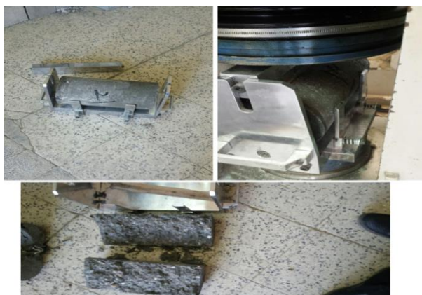
شکل ۴-۱۴ نحوه آماده‌سازی و آزمایش نمونه‌ها در حالت فاصله ۴ سانتی متری از تار خنثی
