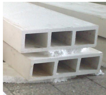
شکل ۱- پانل کامپوزیت مسلح [۱۲]
