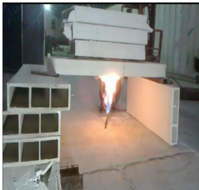
شکل ۱۴- آزمایش مقاومت در برابر حریق [۱۲]
