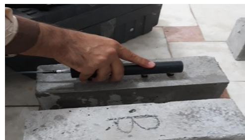
شکل ۱۵- نحوه آزمایش مقاومت ویژه الکتریکی نمونه های منشوری
