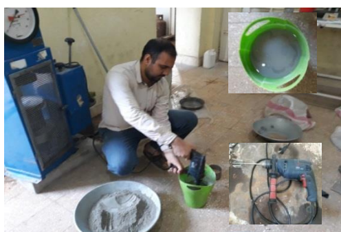
شکل ۸- نحوه تهیه ژل دوده سیلیسی
