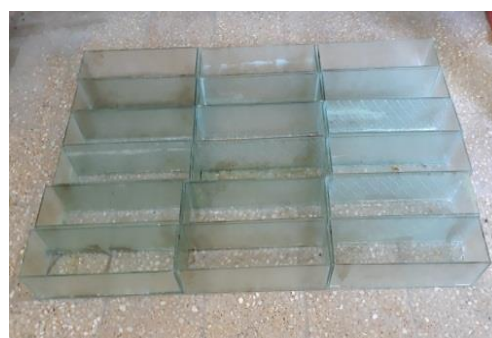
شکل ۷- قالب های شیشه ای ۱۰۰×۱۰۰×۳۵ میلی متر ساخته شده جهت تهیه آزمون برای انجام آزمایشات مقاومت خمشی و مقاومت ویژه الکتریکی
