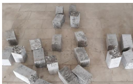
شکل ۱۳- آزمون‌های شکسته شده بتن با دستگاه آزمون خمش سه نقطه‌ای
