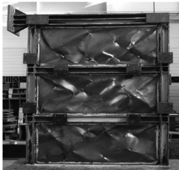
شکل ۲- مدل دیوار برشی فولادی در مطالعه چوی و پارک [۱۳]
