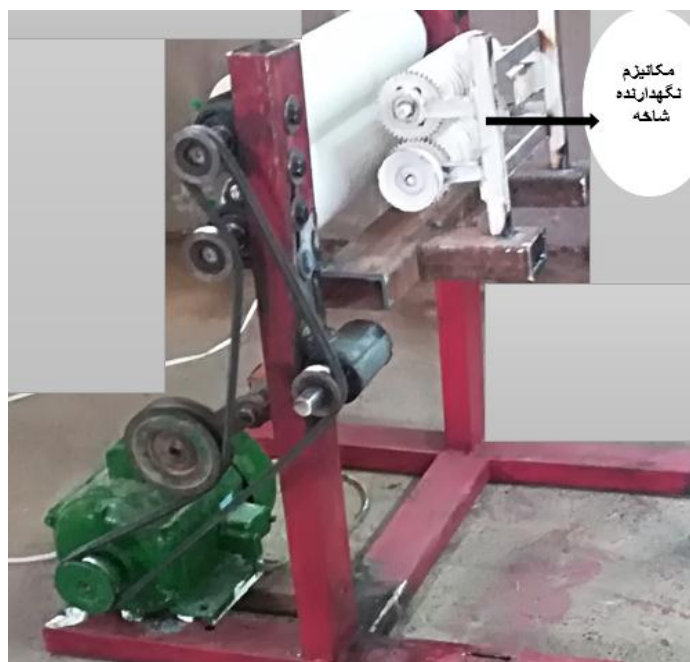
شکل ۲: مکانیزم نگهدارنده شاخه منضم شده به دستگاه جدا کننده برگ
