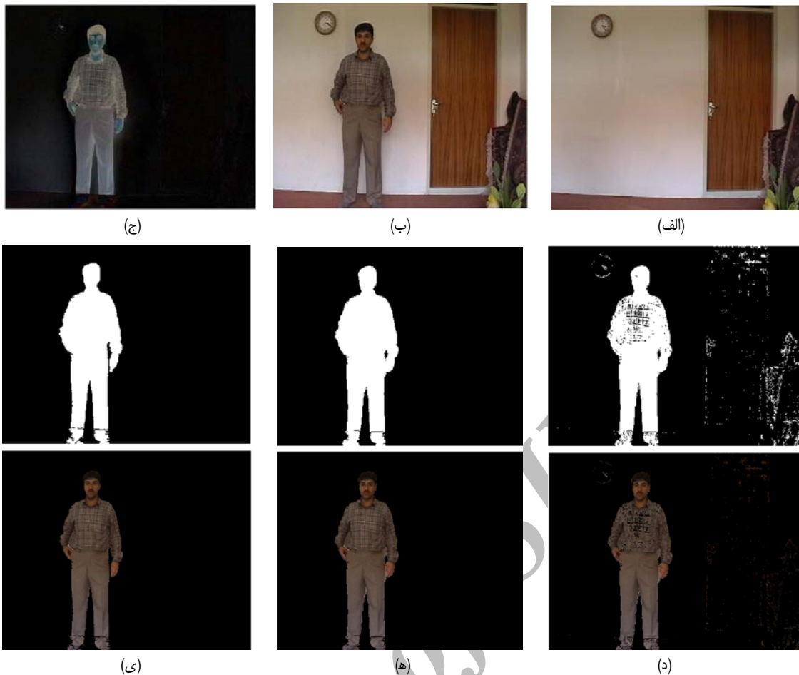
شکل ۱: مراحل حذف پس‌زمینه جهت استخراج نیمرخ جسم مورد علاقه، (الف) تصویر مرجع، (ب) فریم بعدی، (ج) قدر مطلق تفاضل تصویر مرجع و فریم بعدی، (د) حذف پس‌زمینه بر مبنای آستانه شدت نور و رنگ، (ه) بخش بندی بعد از حذف نواحی با اندازه کوچک، (ی) بخش بندی بعد از رشد ناحیه پس‌زمینه جهت کاهش اثر سایه.
