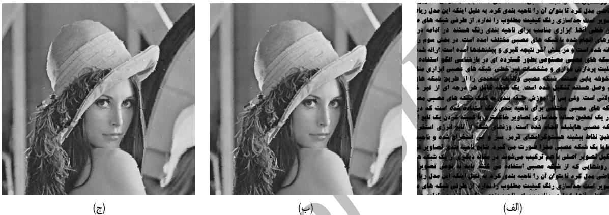
شکل ۹: (الف) تصویر خراب، تصویر ترمیم‌شده به روش استفاده انتشار مبتنی بر موجک با استفاده از موجک مادر، (ب) Haar، (ج) db2، (د) db10، (ه) Bior1.1، (و) Coif1 و (ز) Sym2.
