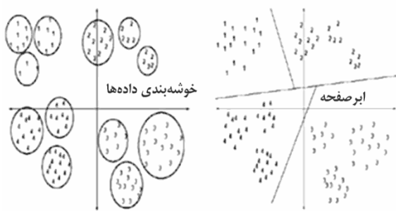
شکل ۶: مقایسه دسته‌بندی‌کننده‌های مولد با دسته‌بندی‌کننده‌های تمایزی (از راست به چپ: دسته‌بندی‌کننده تمایزی، دسته‌بندی‌کننده مولد) [۴۰].
