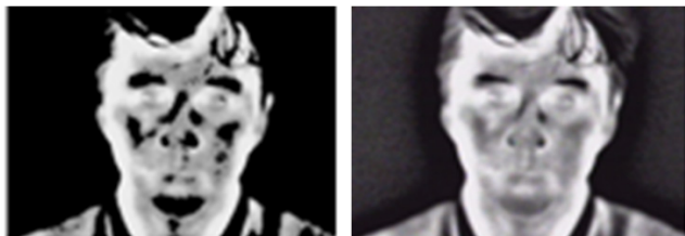
شکل ۶: قسمت‌بندی صورت، (الف) تصویر اولیه و (ب) نتیجه قسمت‌بندی با الگوریتم بیز.
