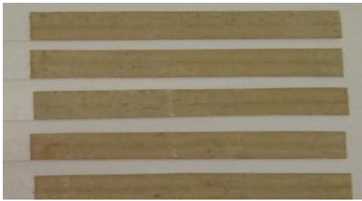
شکل ۳: طرح‌ها یا الکترودهای چاپ‌شده جهت بررسی رسانایی آنها.
