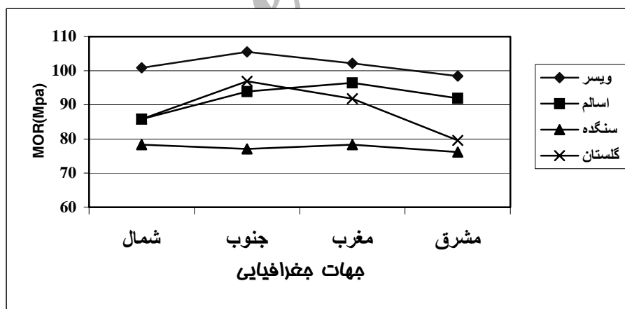
شکل شماره ۳- تغییرات مقاومت به خمش در حداکثر بار با تغییر جهات جغرافیایی در مناطق شمالی کشور (Mpa)
