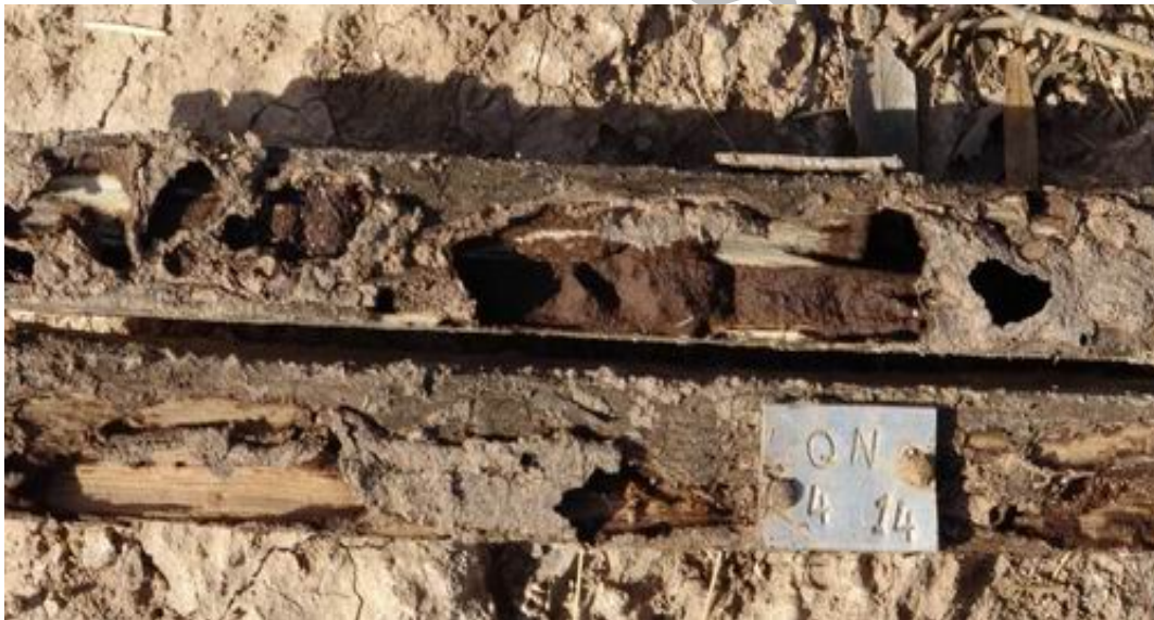
شکل ۴- تخریب نمونه‌های دوام طبیعی بلندمازو پس از ۱۵ ماه استقرار در خاک (ایستگاه الباجی)
