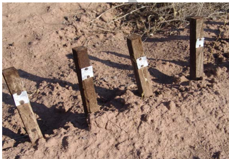
شکل ۷- عدم تخریب نمونه‌های اشباع شده (ایستگاه میش مست)
