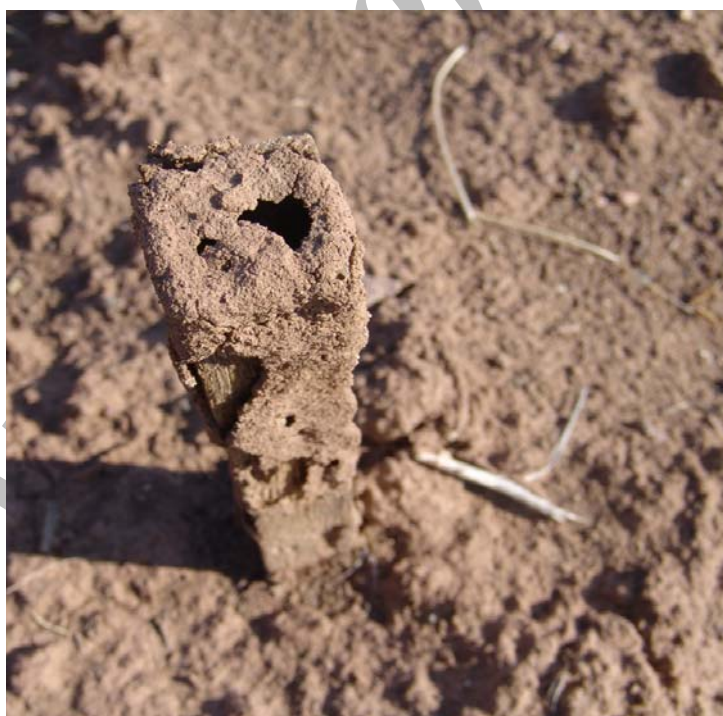
شکل ۵- ایجاد پوشش گلی بر روی نمونه‌ها جهت حفاظت در مقابل نور
