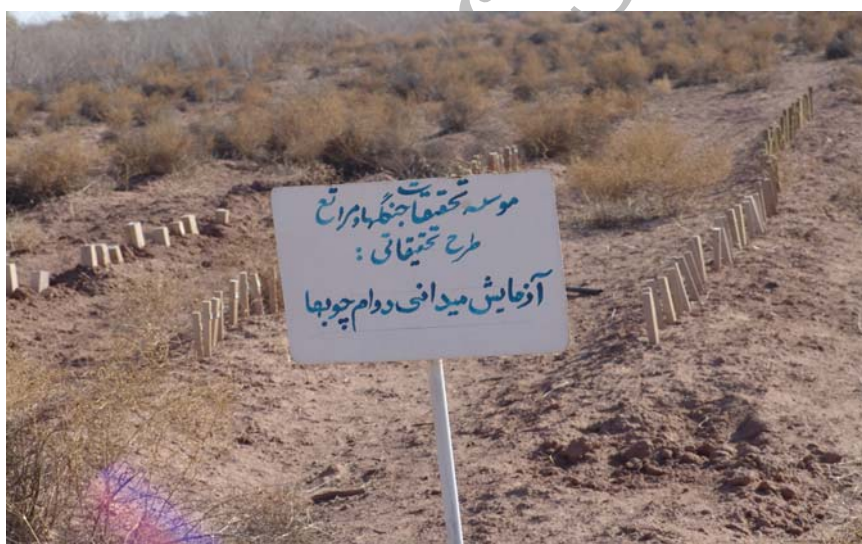
شکل ۳- نصب نمونه های آزمونی در خاک (ایستگاه میش مست)
