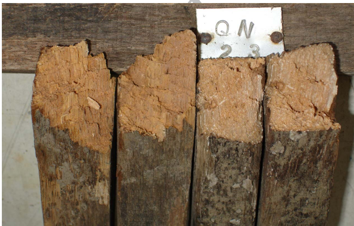
شکل ۳- پوسیدگی شدید در نمونه‌های دوام طبیعی بلندمازو پس از ۳۲ ماه استقرار در خاک در ایستگاه شلمان
