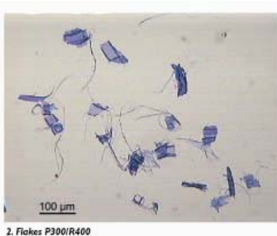
شکل ۱- شکل نرمه‌های رشته‌ای P ۱۰۰/R ۲۰۰ (راست) و نرمه‌های نواری P۳۰۰/R ۴۰۰ (چپ)
