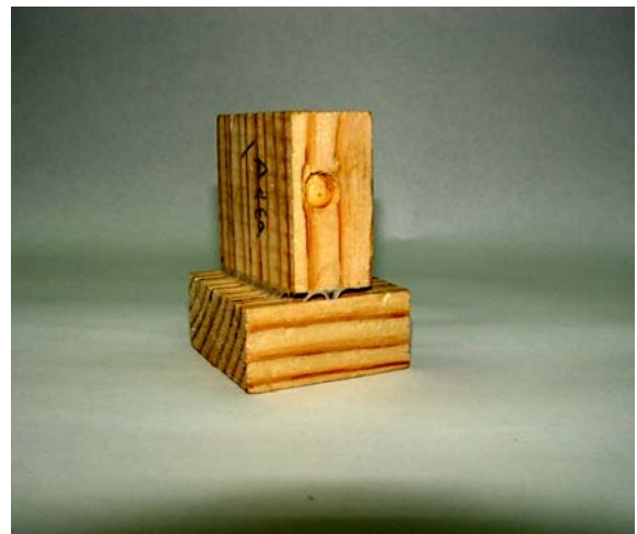
شکل ۳- نحوه شکست و جدایی در دوبل در بررسی مقاومت کششی
