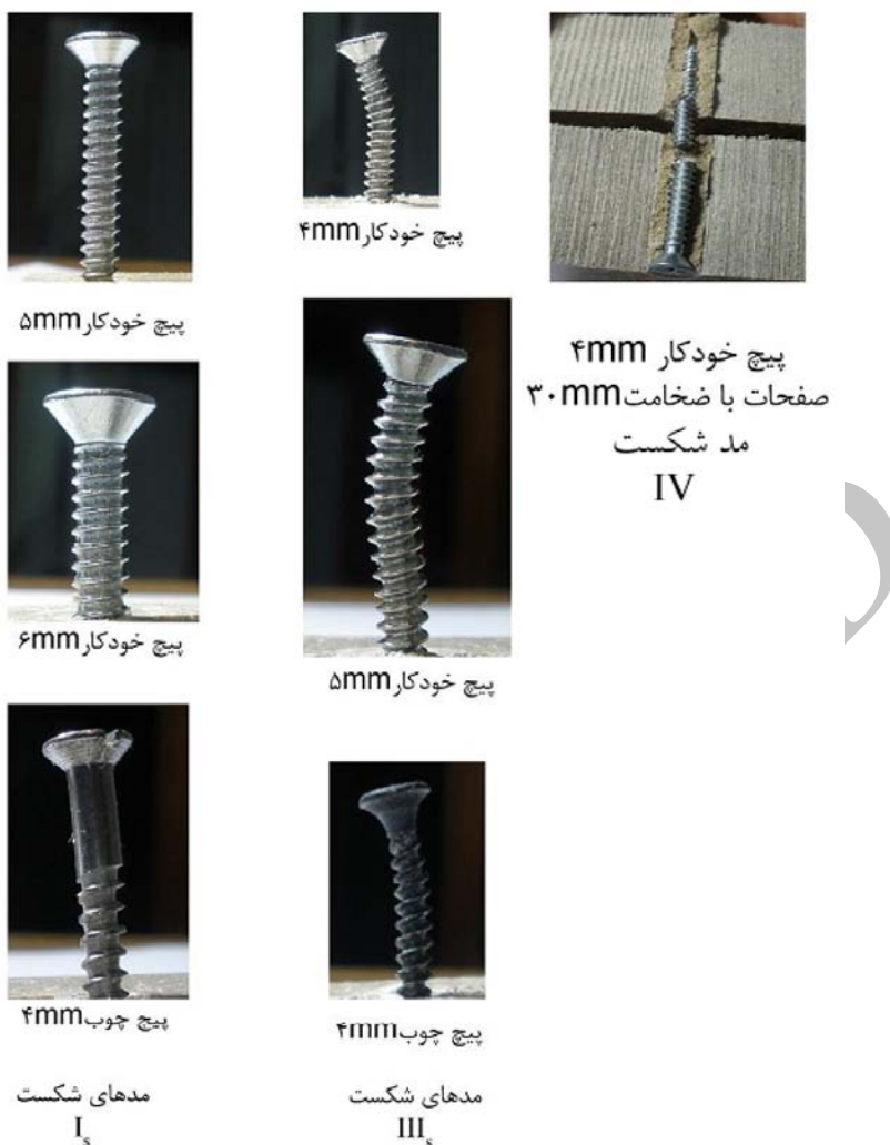
شکل ۳ - نمایی از تغییر شکل پیچ‌های مورد مطالعه زیر بار برشی (تمام پیچ‌هایی که با مد شکست I_s و III_s شکسته‌اند با ضخامت ۱۵mm آزمون شده بودند).
