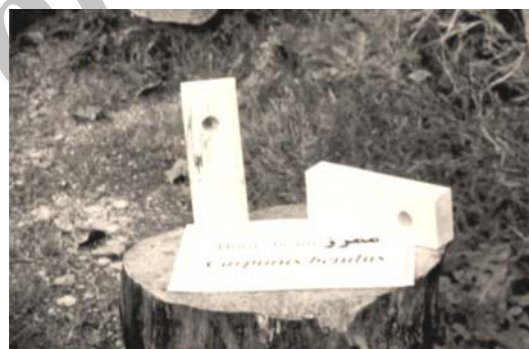
شکل ۱- نمونه‌های آماده شده ممرز برای طناب‌کشی و نصب در دریا
