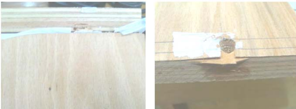
شکل ۹- شکست اعضای اتصال در اثر کاهش فاصله بین لبه سوراخ پین با لبه عضو (در پین به قطر ۱۰ میلی متر)
