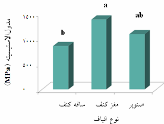
شکل ۳- اثر مستقل دانسیته و نوع فیبر بر مدول الاستیسیتة تخته فیبرهای آزمونی
