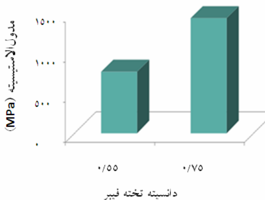
شکل ۳- اثر مستقل دانسیته و نوع فیبر بر مدول الاستیسیتة تخته فیبرهای آزمونی
