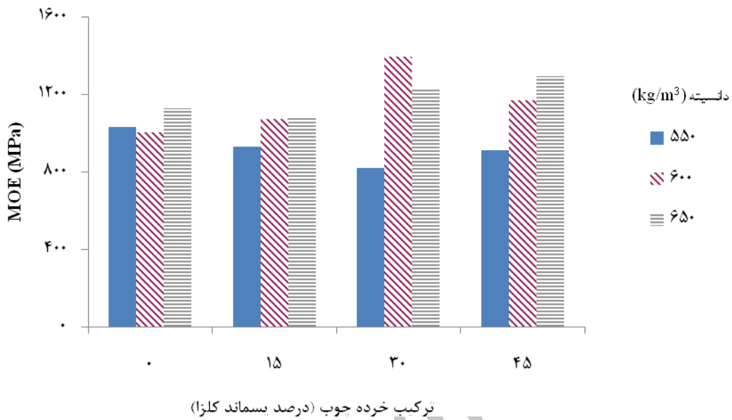
شکل ۲- مدول الاستیسیته تخته خرده‌چوب از ترکیب خرده‌چوب پهن برگ صنعتی و بسماند کلزا
