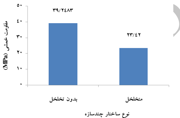
شکل ۶- اثر مستقل نوع ساختار چند سازه بر مقاومت خمشی
