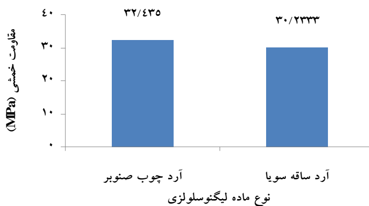
شکل ۷- اثر مستقل ماده لیگنوسلولزی بر مقاومت خمشی
