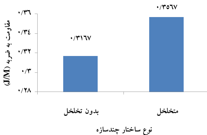
شکل ۱۴- اثر مستقل ساختار چند سازه بر مقاومت به ضربه
