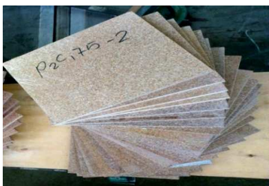
شکل ۱- نمونه‌هایی از تخته‌های آزمونی
