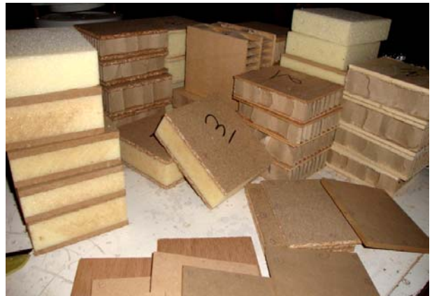
ج: پانل‌های ساندویچی سبک وزن شکل ۱- مغزی‌های مورد استفاده در ساخت پانل ساندویچی سبک‌وزن
