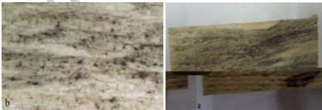
شکل 1 چوب‌های آلوده به قارچ عامل تغییر رنگ؛ (a) ماکروسکوپی و (b) میکروسکوپی (استریومیکروسکوپ).
