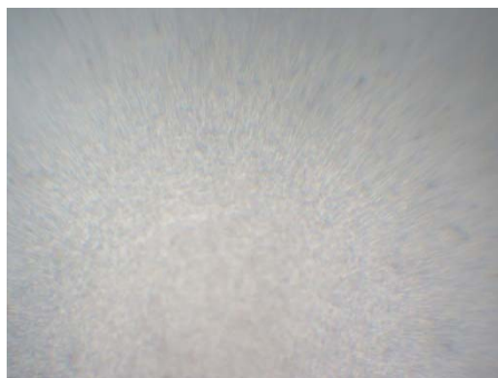
شکل ۷- تصویری از پساب قبل از لخته سازی (بزرگنمایی ۲۰×)
