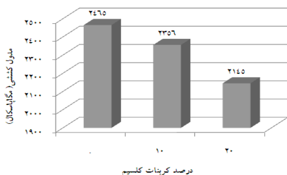
شکل ۲- اثر مستقل درصد کربنات کلسیم بر خواص کششی چندسازه چوب پلاستیک
