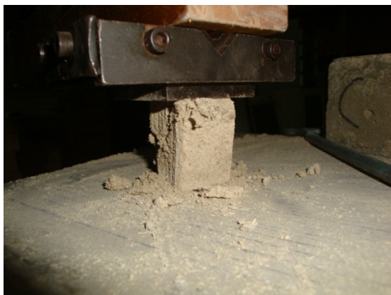
شکل ۶- نمونه فشاری در حال آزمایش
