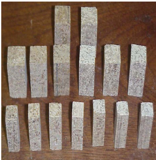
شکل ۴- نمونه‌های آزمایش فشار تخته چوب سیمان به ابعاد مناسب بریده شده
