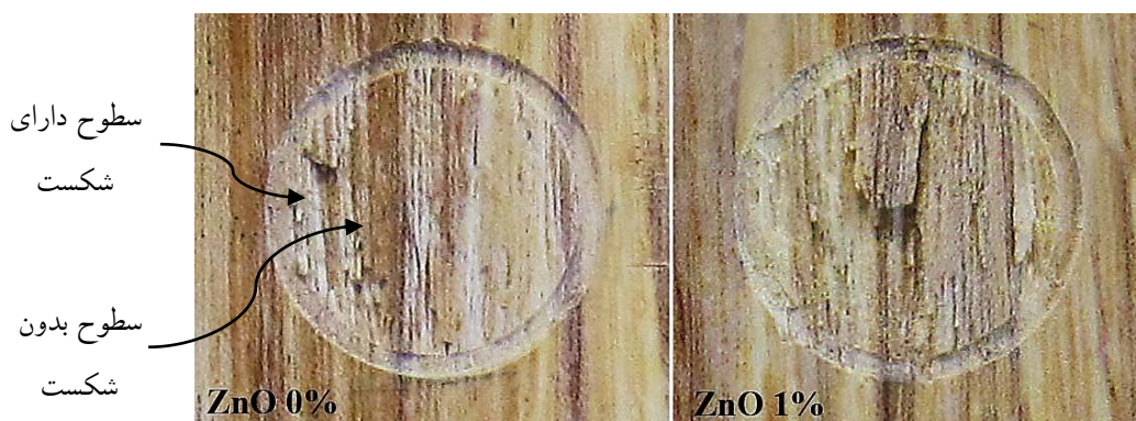
شکل ۸- سطح شکست چوب به همراه پوشش در گونه ملچ طی آزمون مقاومت چسبندگی پوشش
